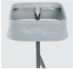
Spannring des Haftringes nach unten klappen.
